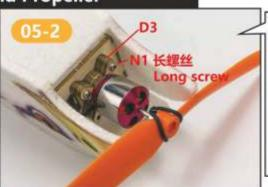
把马达固定到防火板上。此时根据你所选马达的大小垫入D3,调整到合适长度。
