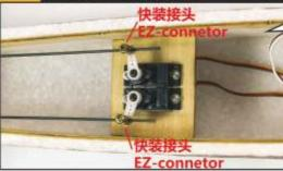
在机身中部安舵机,舵臂上安 装快装接头,钢丝连杆穿入快 装接头并锁定。 Install the serve in the
