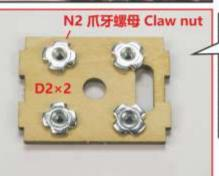
在机身头部粘贴马达防火板,注意装有螺 母一面朝机身内。防火板2片粘在一起, 并装爪牙螺母。
