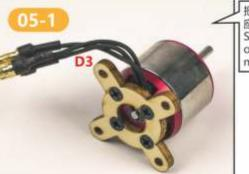
把马达固定到马达 座D3上。 Secure the motor onto the motor mount D3.
